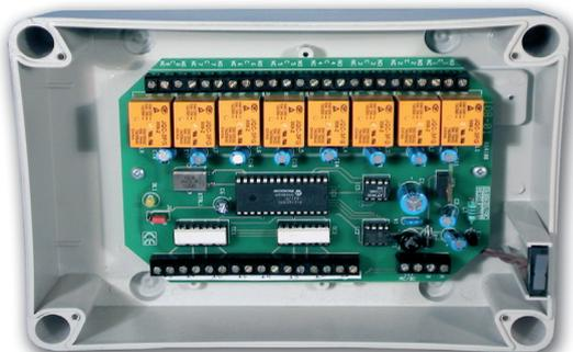
Boîtier auto protégé à l'ouverture par micro interrupteur.
